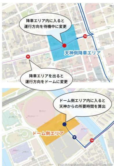
図2 GISサーバーによる動的な運行方向の設定と所要時間の算出
