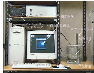
当研究室にて試作した電気抵抗方式トモグラフィ計測システムの写真(ステンレス丸棒を挿入・静置させた測定)
