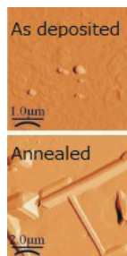
図：テラヘルツ領域の誘電分散とAFMイメージ。膜質の違いが誘電率に反映されている。
