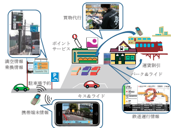
図2 駐車場を高度化するITS技術の例
