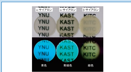
図1 透明サイアロン蛍光バルクセラミックス
