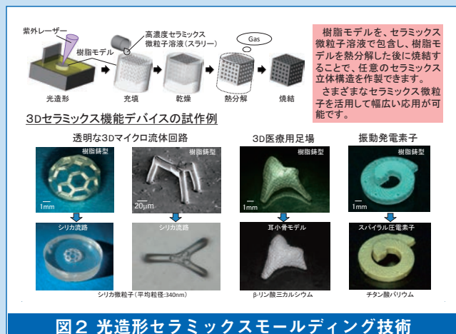
図2 光造形セラミックスモルディング技術
