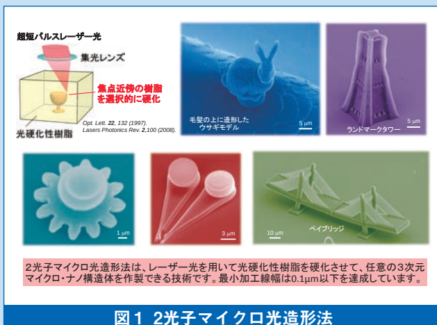
図1 2光子マイクロ光造形法
