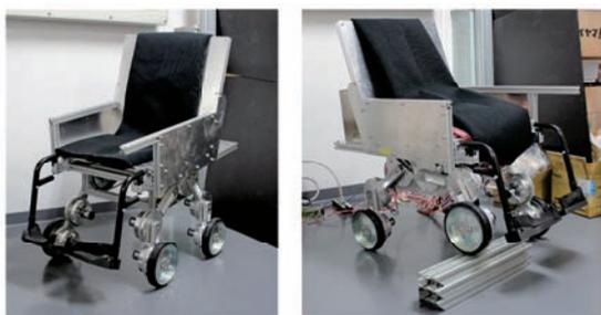
図1 4脚4輪自律移動車いすロボット（脚を上げた所(右)）
