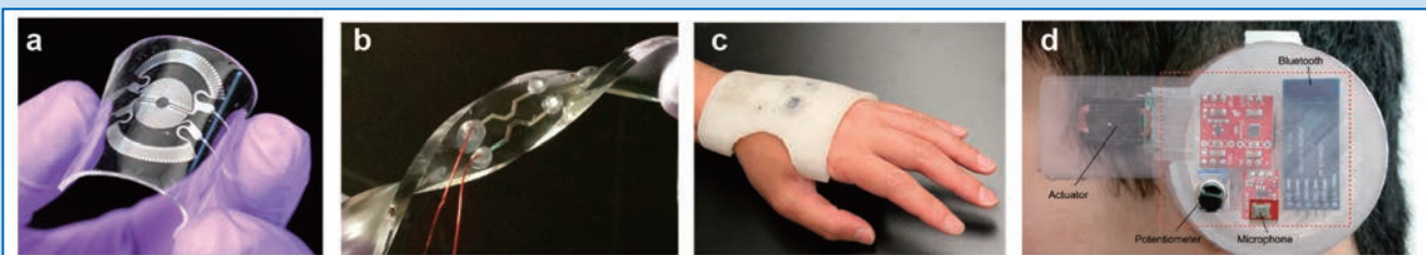
ソフトマテリアルによる大変形センサーとスマートデバイス。a. 液体金属圧力センサ、b. 液体金属による温度センサ、c. 3Dプリンティングによるスマート電熱グローブ、d. 深部体温計測のためのイヤラブルデバイス
