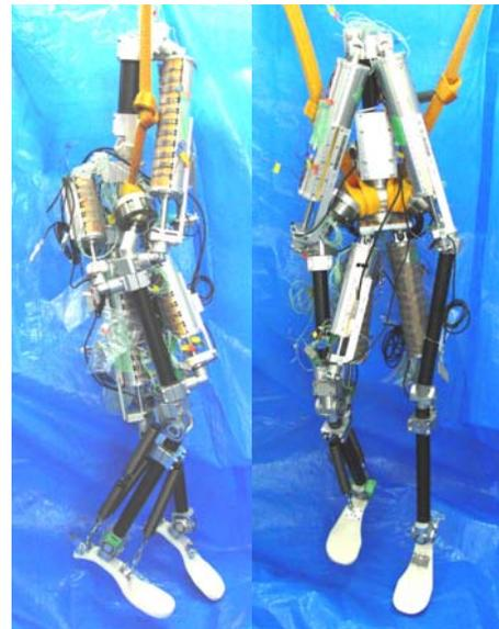
開発した筋骨格ロボット
