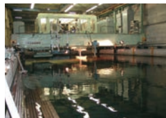
船舶模型の曳航・自航実験 通常船舶・漁船等の小型船の模型曳航実験・自航実験
