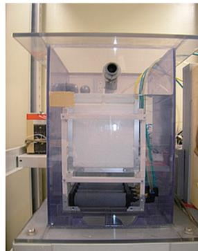
図2 PTFE平膜を適用した膜分離活性汚泥法の反応槽。(Nittami et al., 2014 J Membr Sci 463 183-189)
