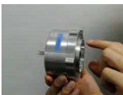
減速比 1/97 の開発ギヤのバックドライブの様子
