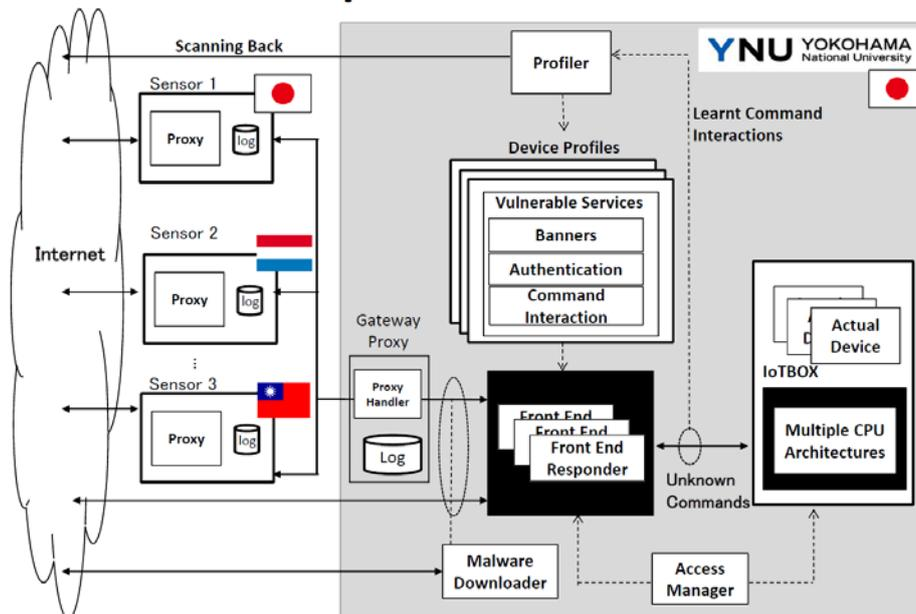
IoT 機器へのサイバー攻撃を観測する仕組みである IoTPOT は世界各国に分散配置されるセンサ群(本年度中に 10 か国に展開予定)と横浜国立大学内に構築されたバックエンドシステム(図の灰色部分)からなります。センサに届くサイバー攻撃は全てバックエンドシステムに転送されます。バックエンドシステムではセンサ群を通じて世界中から届くサイバー攻撃に対して、セキュリティレベルの低い機器を模擬した応答を行うことで、攻撃者を惹きつけ、攻撃の観測、分析やマルウェア(不正プログラム)の収集を行います。
