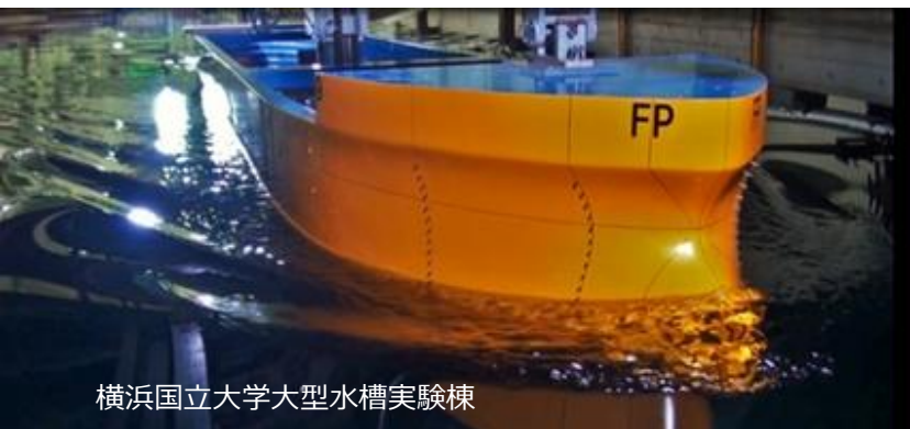
船舶の性能予測のための模型試験(左)と数値シミュレーション(右)
