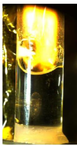
写真：宇宙機推進剤用イオン液体の開発(JAXAとの共同研究)
