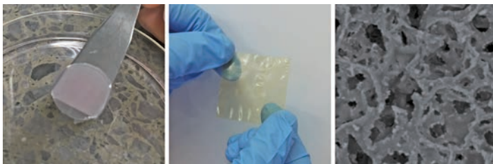
図 事例紹介：(左) 軟骨再生足場、(中央) 多糖複合フィルム、(右) 多孔質ヒドロキシアパタイト
