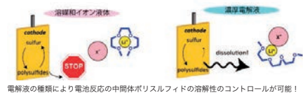
電解液の種類により電池反応の中間体ポリスルフィドの溶解性のコントロールが可能！
