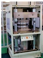
1. 世界初：水圧駆動樹脂封止100トンプレス
