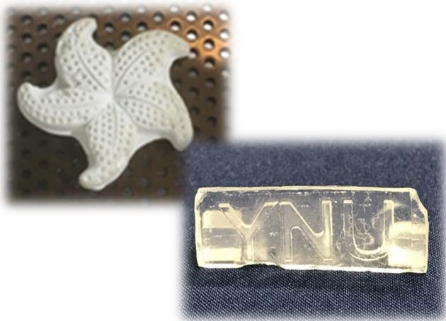
光で固まるセラミックス造形用インクから作製した複雑形状セラミックス
