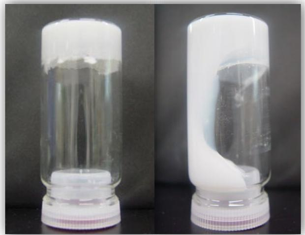
粒子を溶媒に懸濁した様子。液中で大きなダムを形成して固化する場合もあれば、流れてくれる場合も。
