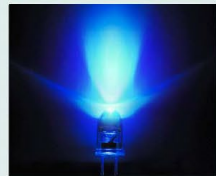
青色LED。車のヘッドライトでは黄色などの蛍光灯に当てて明るい白色光をつくっている。
