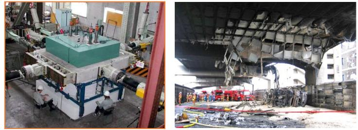
写真：上) 高温加熱時の構造部材の損傷と鎮火後の応答を数値計算で評価 右下) 火災事故後の橋梁の様子 左下) 計算モデル検証用の構造実験
