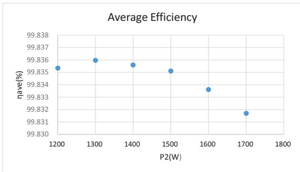
図5 SiC-HEECS インバータの効率 (#3L)
