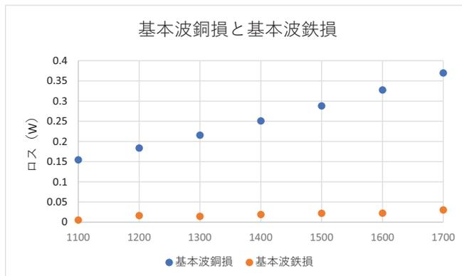
図 3 #3L の基本波銅損と基本波鉄損
