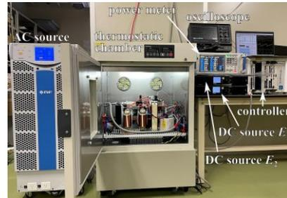
図 2 測定器を含む実験装置の外観
