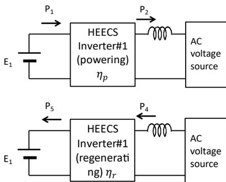
図 3 VTASLM 測定系(上:力行、下:回生)
