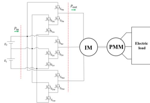
図 14 HEACS 三相インバータによるモータ駆動系の結線図
