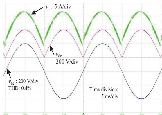
図7 HEECS インバータの各部の波形<sup>(1)</sup>
