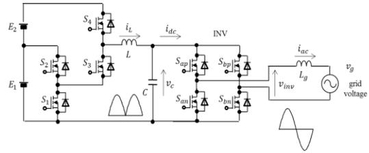
図 12 HEACS インバータの系統連系の結線図
