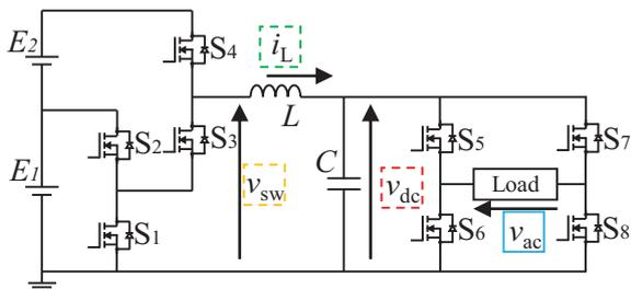
図1 2電源 HEECS インバータの回路トポロジー
