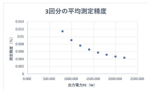
図 4 VTASLM 法による変換効率 (上) とその測定精度 (下)
