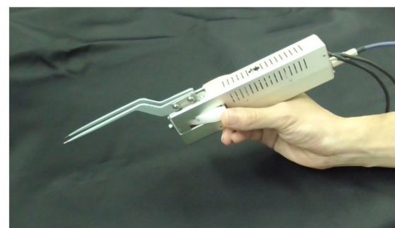
鑷子(せっし)型ハプティックデバイス試作機
